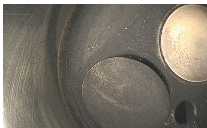
Ein- und Auslassventil des 1. Zylinders
