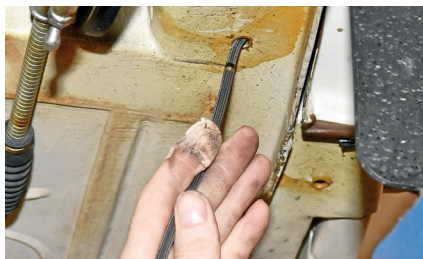
Bewegliche Endoskopiespitze wird in den Fahrzeugrahmen eingeführt
