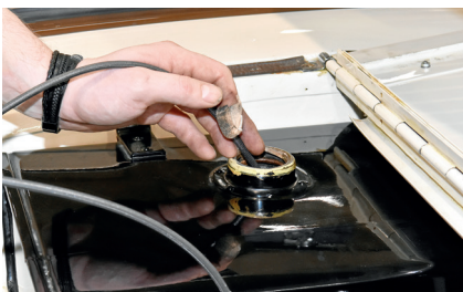
Über den Tankeinfüllstutzen wird das Endoskop eingeführt
