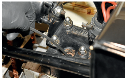
Einführung der Videoskopiesonde über die Zündkerzenbohrung
