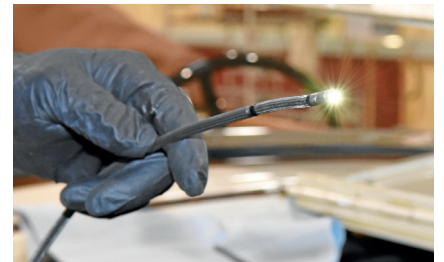
Bewegliche und steuerbare Videoskopsondenspitze
