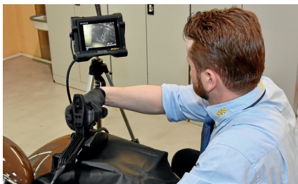
Endoskopie des Getriebes über die Bohrung des Ölpeilstabes
