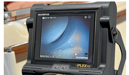
Auf dem Monitor ist ein endoskopiertes Ventil zu sehen.
