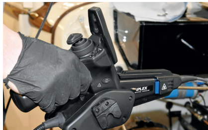
Handheld-Bedienteil mit Joystick zur Steuerung der Videoskopkamera
