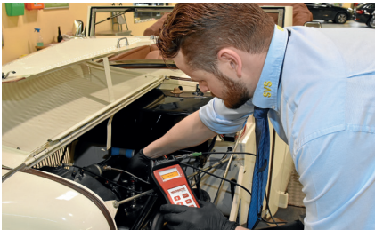
Durchführung eines Kompressionstestes
