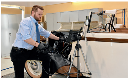
Endoskopie mit dem Olympus IPLEX RX Videoskop
