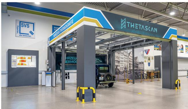
Ein neuartiges Car-Check-System, das mit einem 360°-Thermografie-Fahrzeugscanner präzise und äußerst erfolgreich die Prüfbereiche der gesamten Fahrzeugoberfläche – einschließlich des Daches und der Motorhaube – vermisst und visualisiert.
