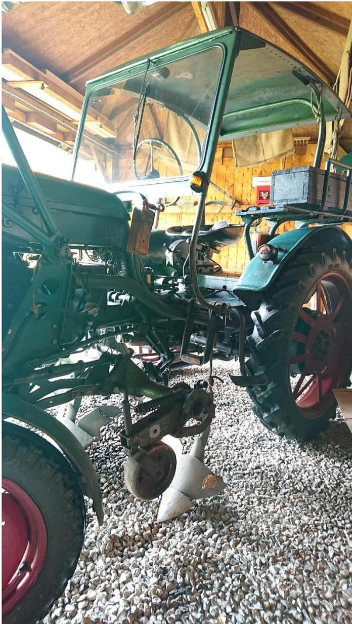
@ Häufelgerät für Zwischenachsenbau mit Rahmen, Scharen sowie Stützrad hierfür zum Rangieren des Gerätes.
