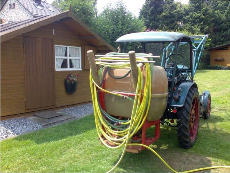
Feldspritze, umgebaut zum Ansaugen und Spritzen aus externer Wasserquelle oder aus dem aufgebauten Wassertank. Ansaugschlauch und Spritzschlauch sind an Gerät aufgewickelt. Wurde gereinigt und danach nur für Regenwasser verwendet. Undichtigkeiten an Verschlauchung, muß neu eingedichtet werden.
