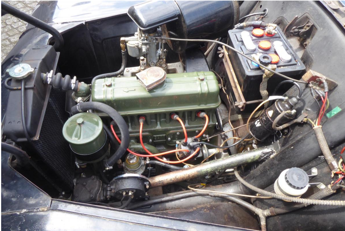
B4B-Vierzylinder-Reihenmotor (Inline-Four B4B) 1414 ccm
