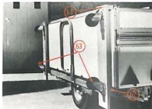
füsse sich befinden, hinter dem Metallprofil vom Rapido deckel geklemmt. Dabei wird die Unterseite von der Kippvorrichtung (62) gegen den Caravan gedrückt, so dass es sich unter dem Aufbau festklemmt. Beim Kippen werden die Räder (63) nach oben gedreht. Jetzt kann der Caravan am einfachsten von 2 Personen umgekippt werden. Wenn Sie den Rapido wieder auf die Räder stellen wollen, handeln Sie genau umgekehrt.
